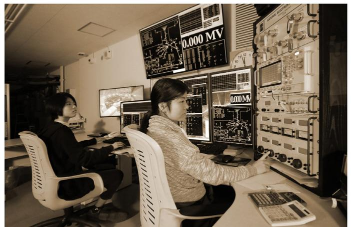
6MVタンデム静電加速器の制御コンソール
