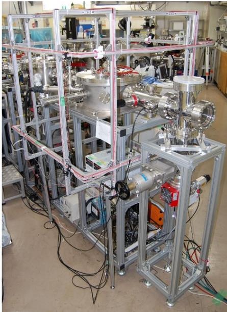
図1: 1MVタンデトロン加速器の高速クラスタービームライン
