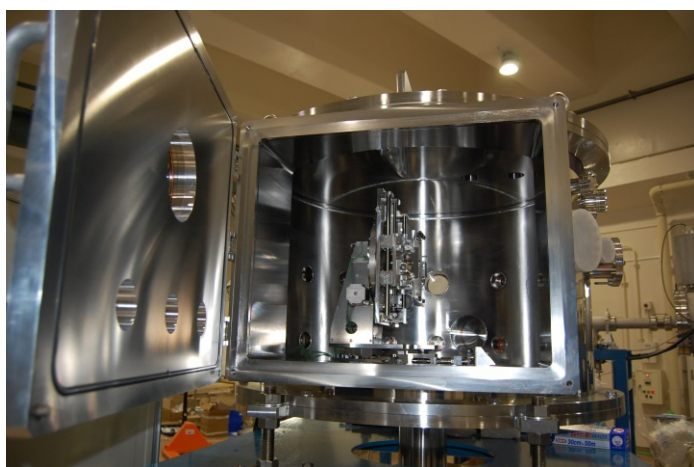
図1: 宇宙用半導体素子等のイオンビーム照射実験用の真空散乱槽(直径1m、高さ0.7m)。内部にはA5判の面積を走査できるターゲット駆動機構、ターンテーブル、スリットなどが取付けられている。
