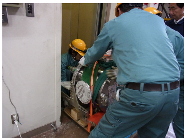
図 1 8 デュオプラチャンバー移設作業
