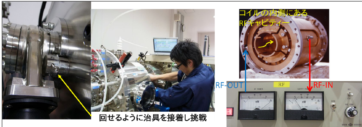
図 2 RF 調整トリマーで最適な共振ポイントにする試み
