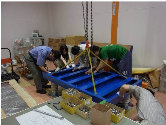
図2 高電圧架台の仮組み
