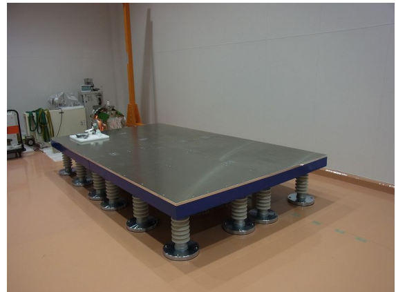
図5 出来上がった高電圧架台
