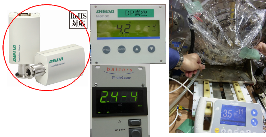
図23 問題のヘッドと悪い真空時のゲージ2つ、リークがない行き詰まり状況
