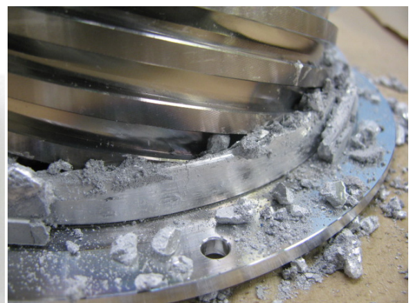
図20 低真空用ねじ溝羽根がボロボロに
