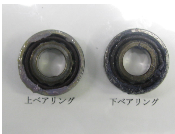
図19 高速回転で焼き付いたベアリング
